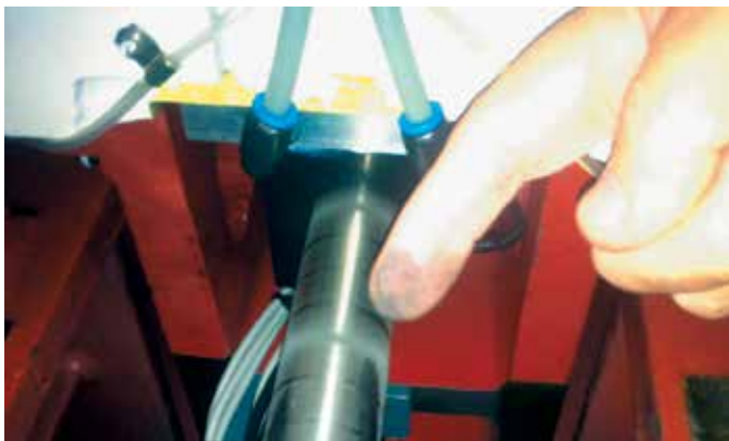
Шток линейного цилиндрического двигателя и трубки системы охлаждения бессердечниковых катушек
